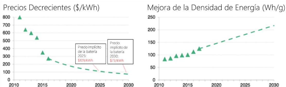
Ilustración 41. Precio y densidad energética de baterías para EV
